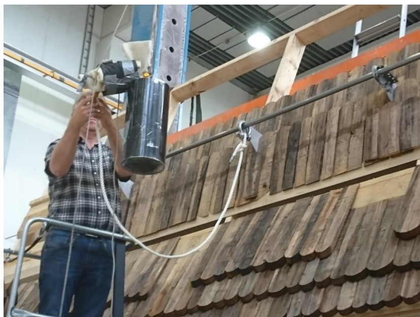
Figur 51. Fallkroppen, 100 kg stål, kopplas in till nockracket. I detta fall provning med lastriktning upp mot nock.
