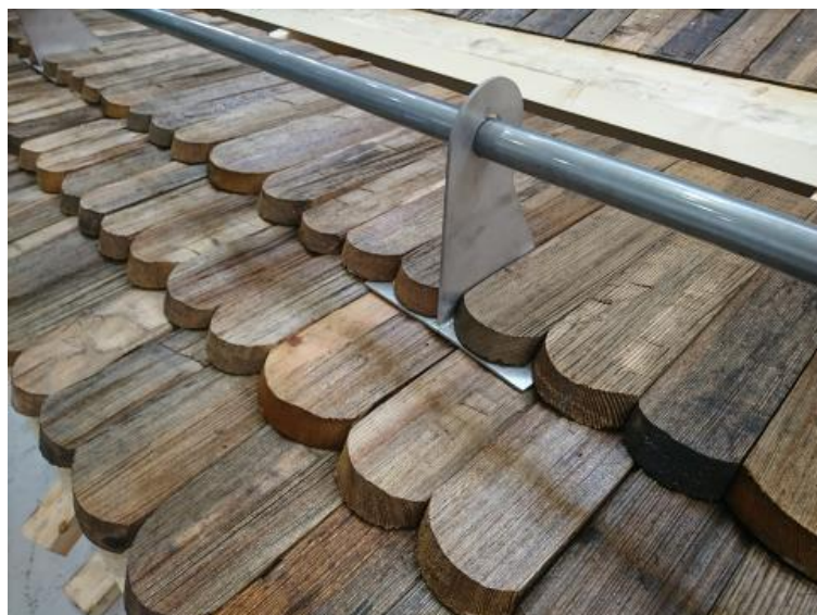
Figur 50. Nockräcke monterad på modell inför provning.
